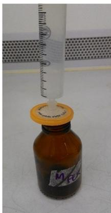
Figura 8: Filtração da solução de maltose
