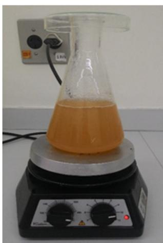
Figura 5: Ágar Sabouraud com cloranfenicol sendo dissolvido em agitador magnético sob aquecimento
