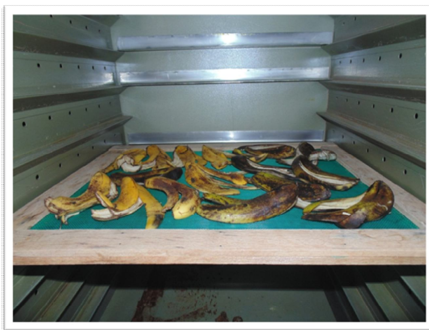
Figura 2: Estufa de circulação de ar, onde as cascas de banana foram secas
