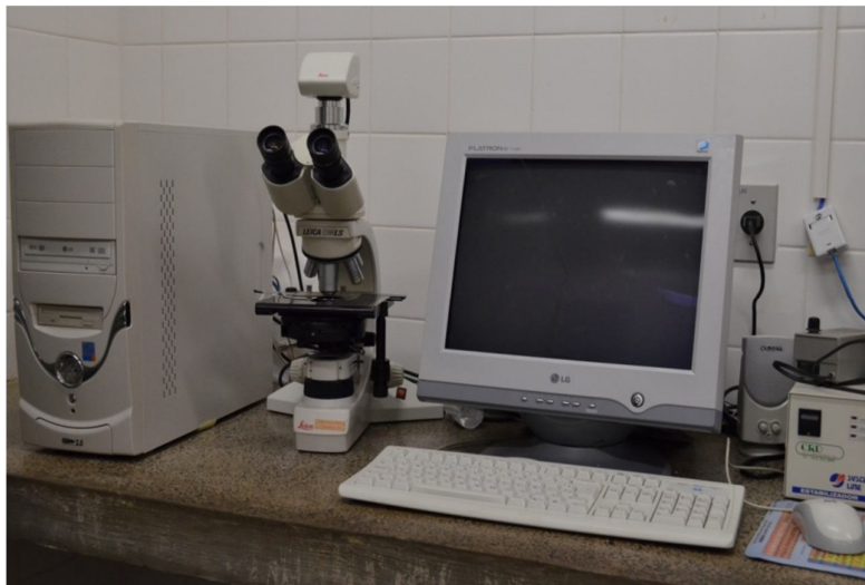
Figura 7 - Sistema de análise de imagem - Micro computador com o software de captura e análise de imagem, acoplado ao microscópio Leica DMLS.
