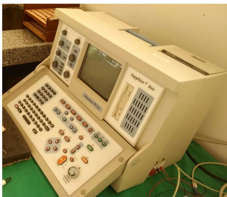
Figura 6 – Eletromiógrafo da marca Sapphire II 4ME utilizado para as análises. Fonte: Arquivo Pessoal
