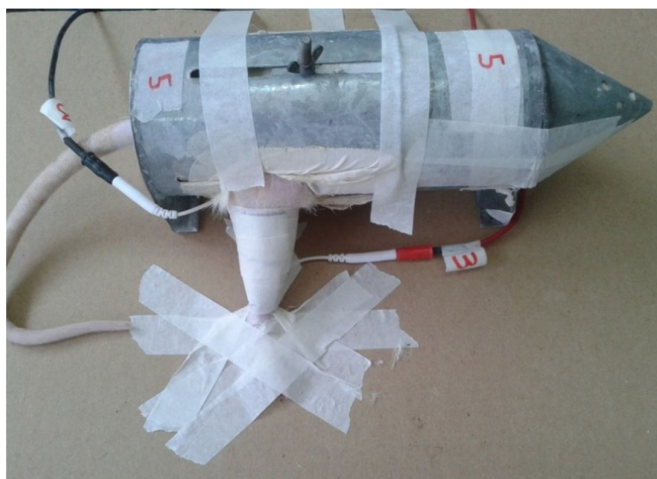
Figura 5 – Cápsula metálica com o animal dentro e eletrodos posicionados sobre o ventre do músculo tibial cranial.
