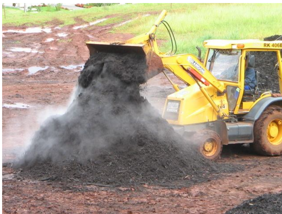
Figura 5 – Revolvimento do lodo de esgoto compostado.
