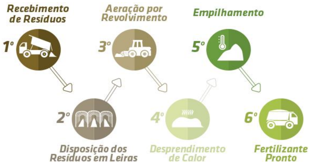
Figura 3 – Processo de compostagem termofílica tera ambiental.
