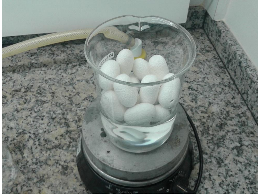
Figura 7 – Fotografia dos 15 casulos do grupo A num béquer, com a adição de 300 mL de água destilada.
