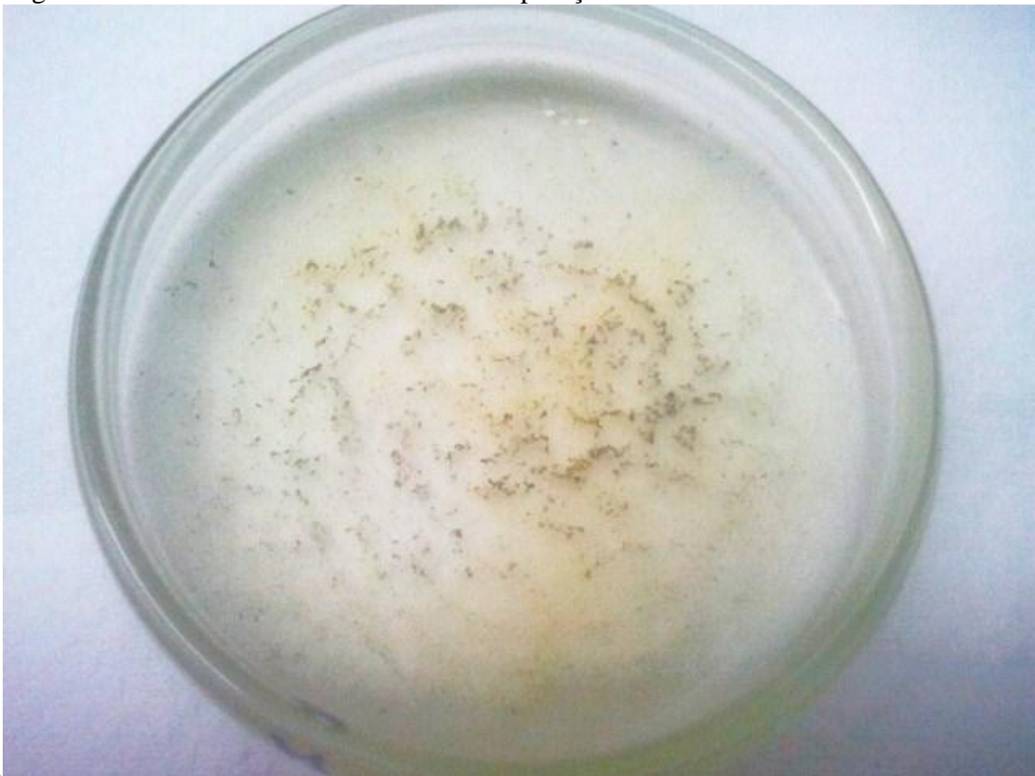
Figura 10 – Sericina sólida resultante da evaporação dos sistemas A e B.
