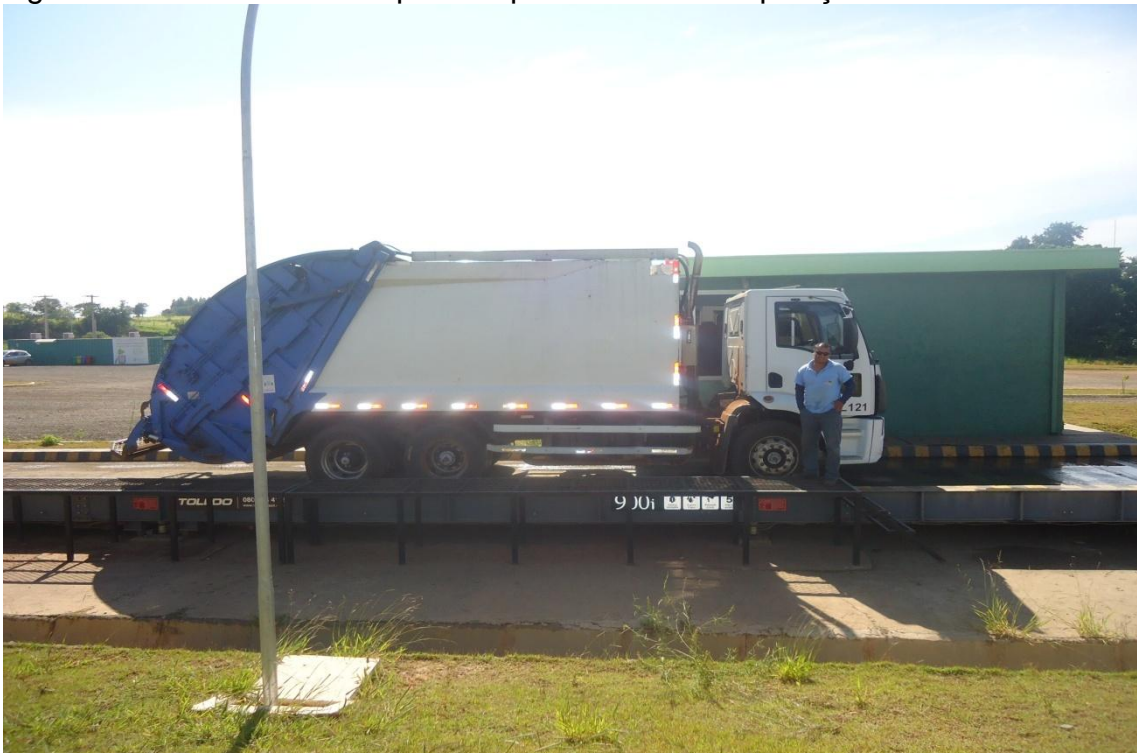
Figura 4 - Caminhão sendo pesado para efetuar a disposição final de resíduos.
