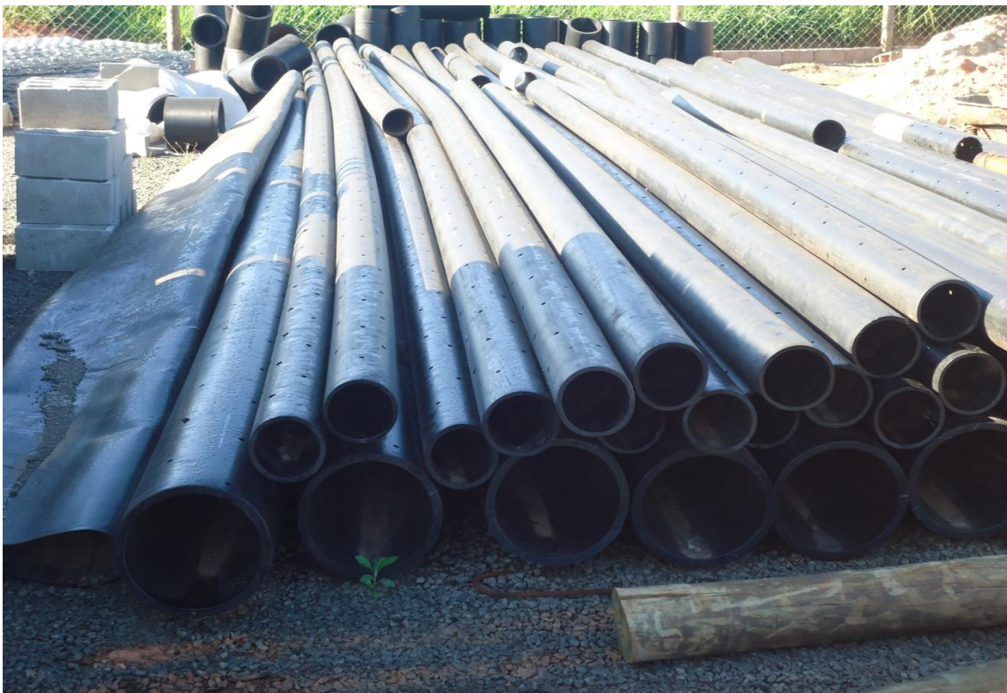
Figura 25 - Tubos de PEAD perfurados utilizados no sistema de drenagem horizontal e vertical de efluentes de Líquidos Percolados e Gases.
