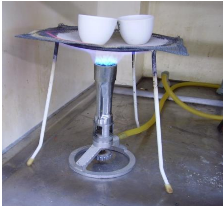
Figura 21 - Determinação de cinzas nas amostras de bagaço. Fonte: Elaborado pelo próprio autor.
