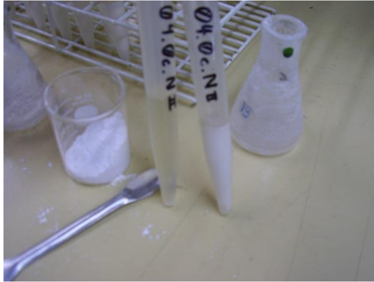
Figura 18 - Neutralização das amostras com carbonato de cálcio. Fonte: Elaborado pelo próprio autor.
