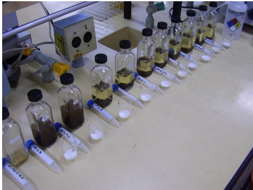
Figura 17 – Amostras Bagaço depois da hidrólise autoclave. Fonte: Elaborado pelo próprio autor.
