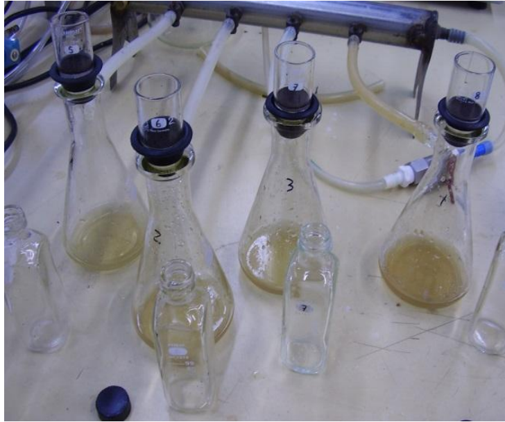
Figura 20 - Filtração do material após hidrólise. Fonte: Elaborado pelo próprio autor.
