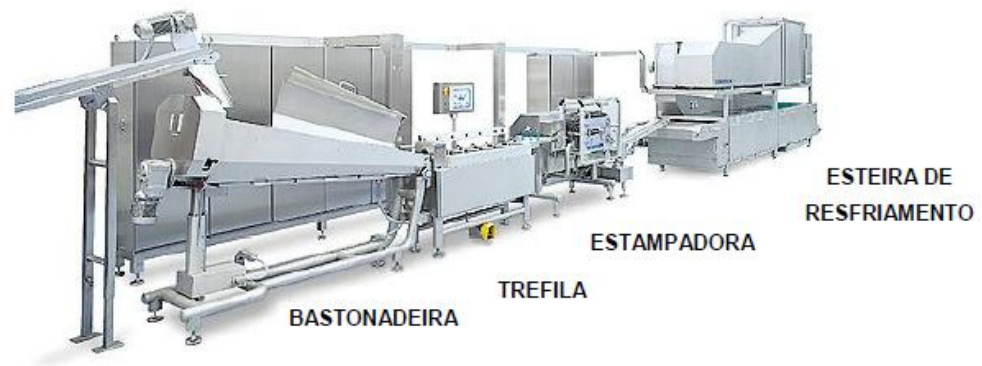
Figura 12 - Conjunto formador para produção de balas duras. Fonte: Adaptado de Chocotec (2009) citado por Spanemberg, (2010).
