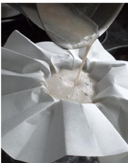
Figura 3. Filtração da amostra em filtro de pregas. Foto tirada em 26 jun de 2012 por: Próprio autor.
