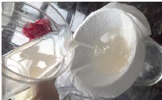
Figura 4. Filtração em filtro microfibras. Foto tirada em 26 jun de 2012 por: Próprio autor.
