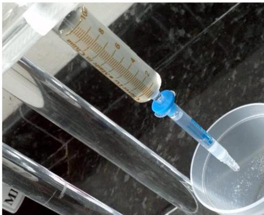
Figura 5. Líquido sendo eluído através da coluna Aflatest. Foto tirada em 26 jun de 2012 por: Próprio autor.
