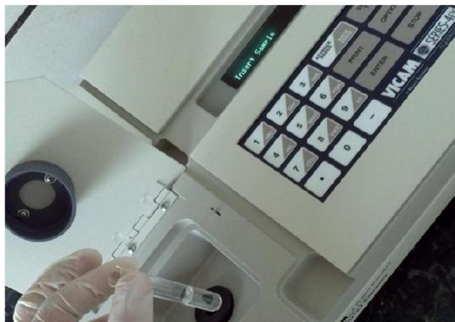
Figura 7. Fluorímetro VICAM SERIE 4EX. Foto tirada em 26 jun de 2012 por: Próprio autor.
