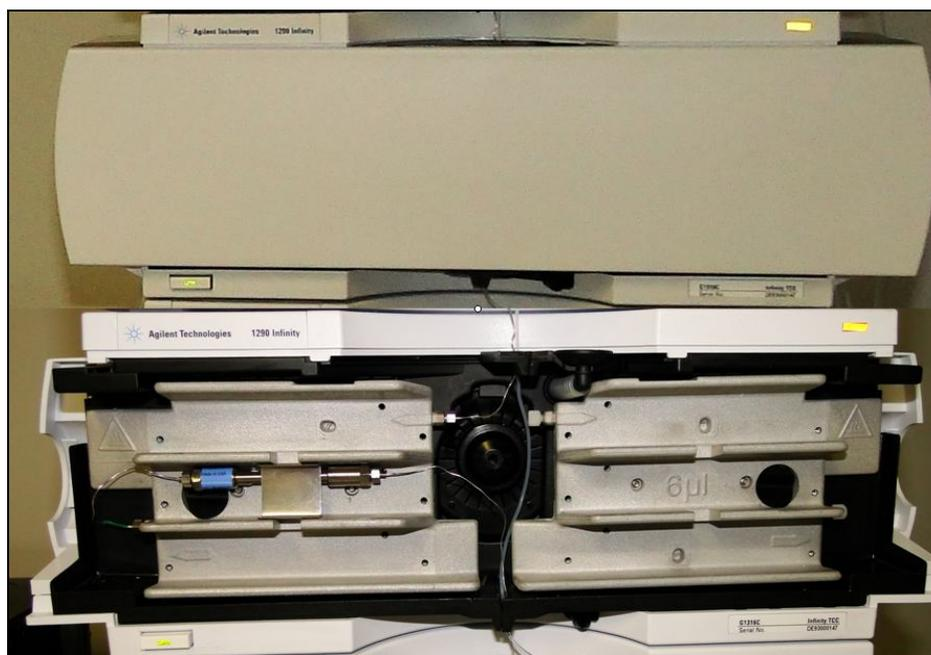
Figura 5 - Compartimento para colunas da *Agilent Technologie* modelo 1290.
