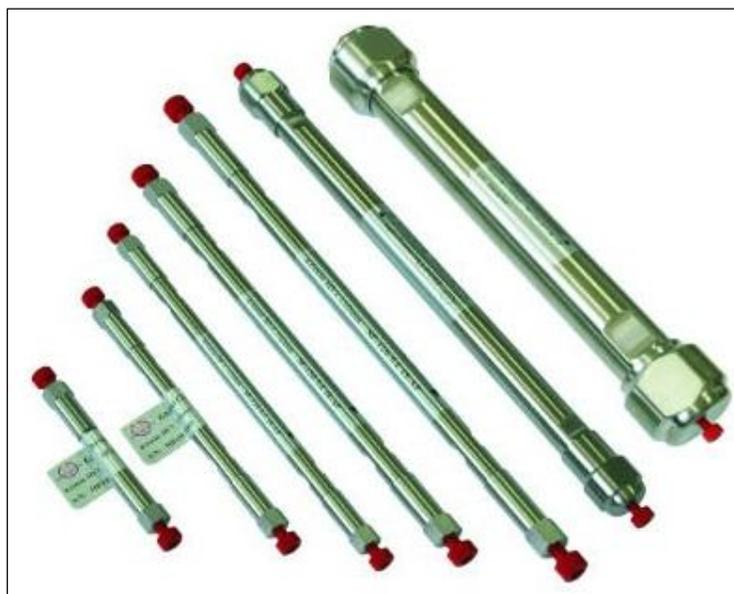
Figura 3- Colunas cromatográficas
