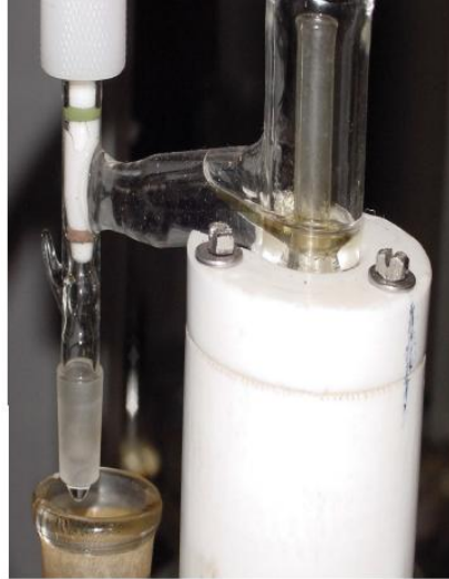
Figura 12: Reservatório do óleo e válvula Fonte: Tavares (2007)
