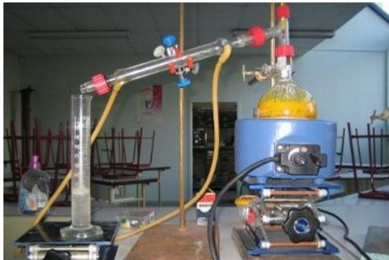
Figura 7: Aparelho de hidrodestilação Fonte: Oleosessenciais (2011)
