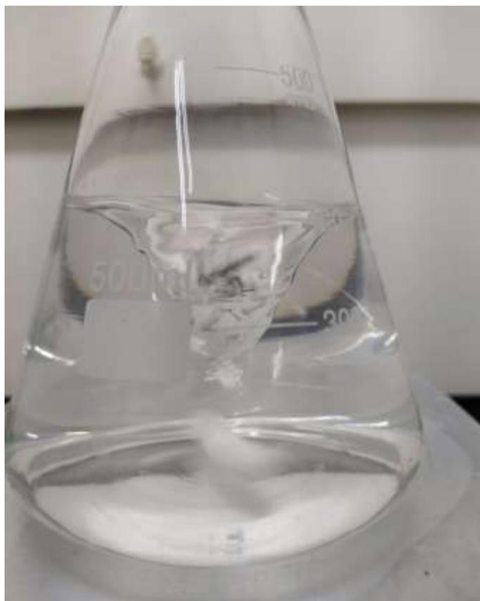
*Figura 13 - Fim do processo de 24 horas de agitação com 3-Glicidiloxipropil Trimetilsiloxano.*
