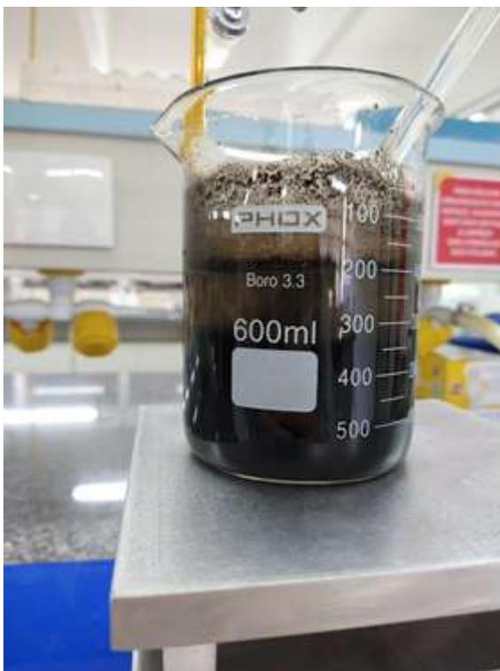
*Figura 5 - Mistura de Nanopartículas 10 minutos após adição de Hidróxido de Amônio.*
