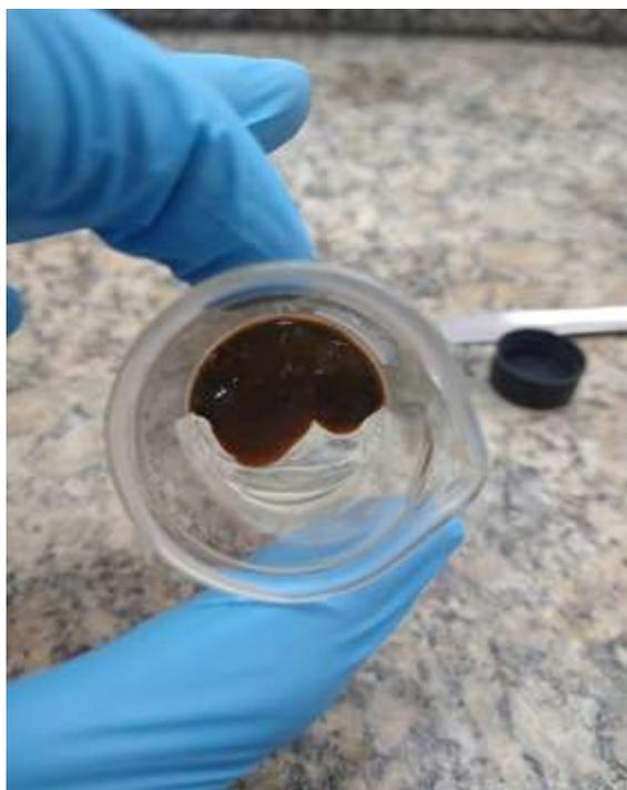
*Figura 15 - Solubilização do Poliestireno Expandido com Acetona P.A.*
