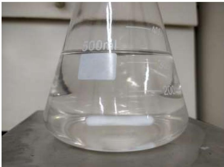
*Figura 12 - Início do processo de agitação com 3-Glicidiloxipropil Trimetilsiloxano*
