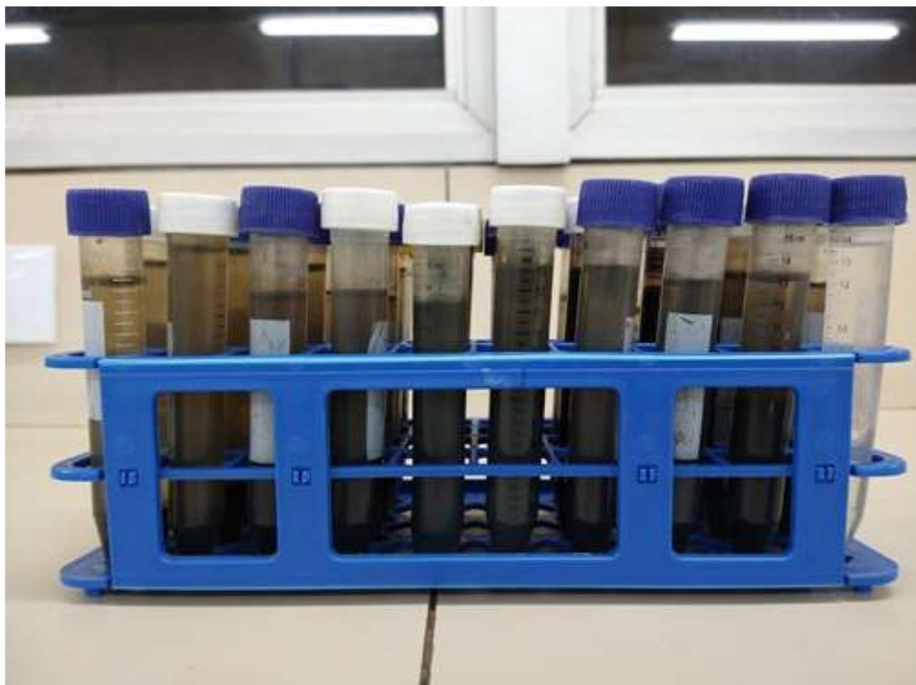
*Figura 6 - Conjunto de Tubos de 15 ml pré centrifugação.*
