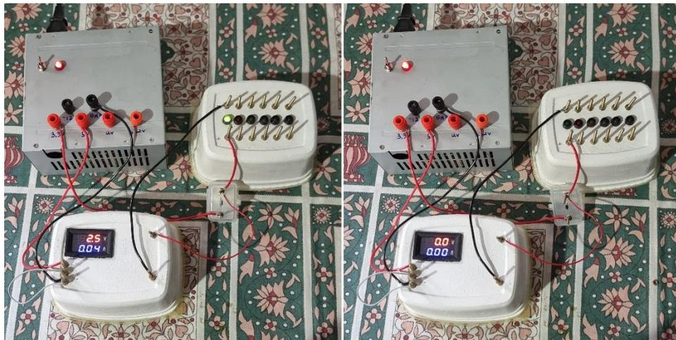
**Figura 10 - Ensaio do Funcionamento do Diodo**
