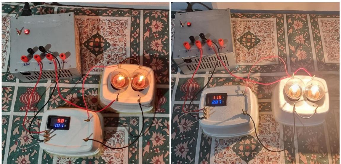
**Figura 8 - Ensaio de Associação de Lâmpadas**
