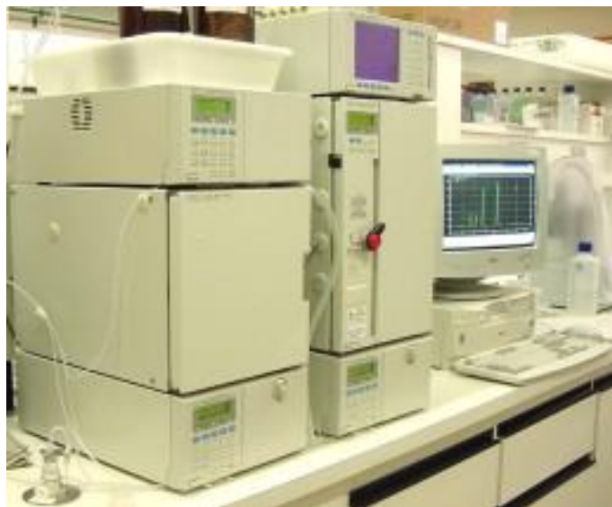
Figura 4 - Aparelho de cromatografia líquida de alta eficiência (HPLC). Fonte: Universidade Estadual de Campinas (c1994-2011).
