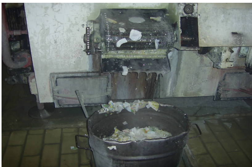
Figura 2: Efluente gerado no extrator de rótulos Fonte: elaborado pela autora.
