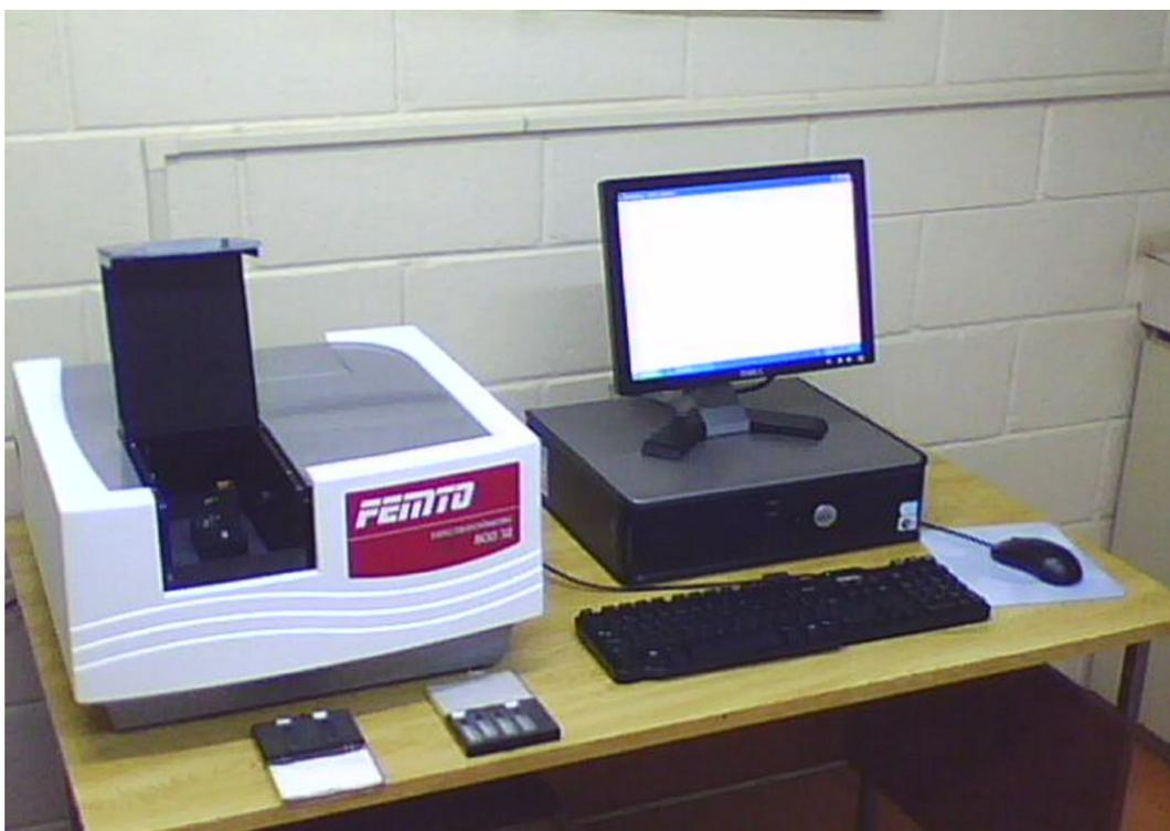
**Figura 8** - Espectrofotômetro de absorção.
