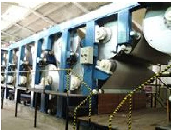
Figura 10: Cilindros acabadores
