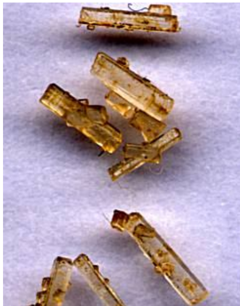
Figura 4: Cristais de açúcar alongados por conta da presença de dextrana. Fonte: THE Dextran Story, [200-] Disponível em: < http://www.opticalactivity.com/dextran/The%20Dextran%20Story.htm >. Acesso em 23 ago. 2010.
