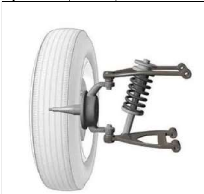
Figura 15 - Suspensão Duplo A
