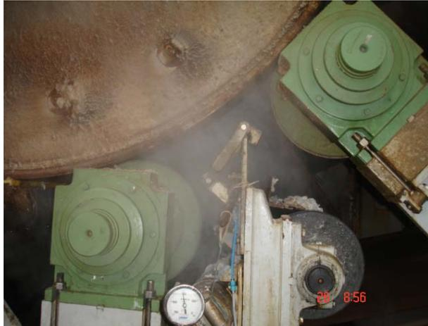
Figura 13 - Secador (*yankee* ou monolúcido)
