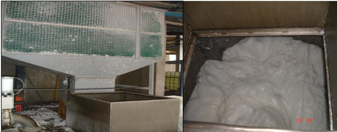
Figura 5 – Preparo da massa (desagregação das fibras)
