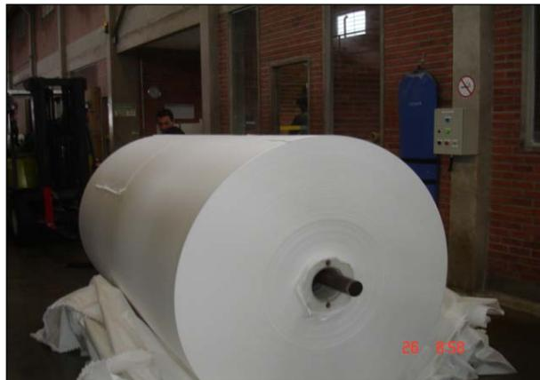
Figura 14 – Rolo jumbo acabado (após passagem pela enroladeira)
