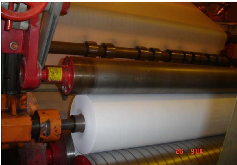
Figura 15 – Papel passando pela rebobinadeira
