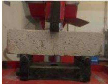
Figura 8 – Ruptura da Peça à Flexão
