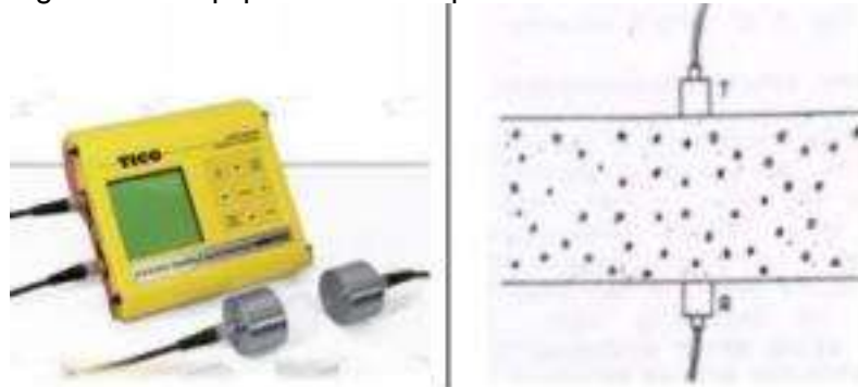
Figura 12 – Equipamento e Esquema do Ensaio de Ultrassons
