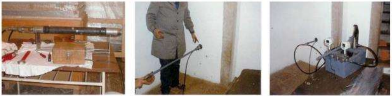
Figura 10 – Ensaio com o Dilatômetro
