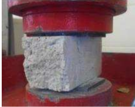
Figura 9 – Ensaio à compressão de uma peça até seu cisalhamento
