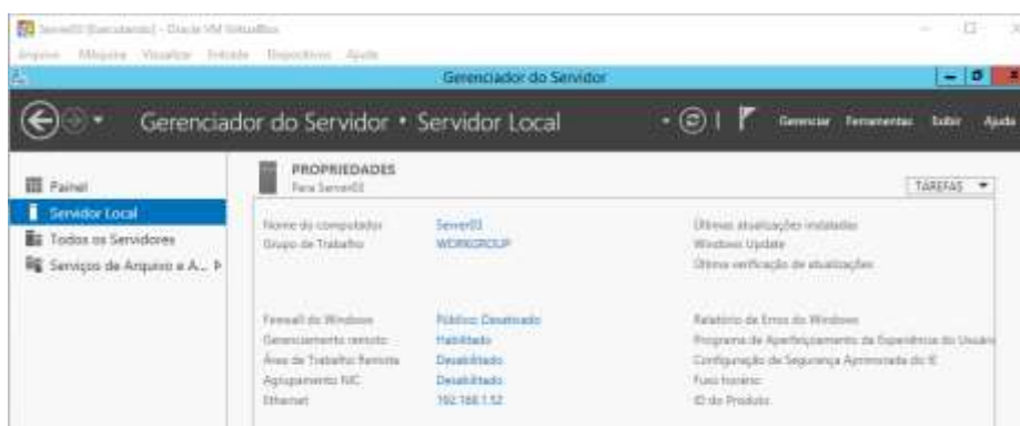
Figura 12 - Alteração de nome e IP da máquina 3.
