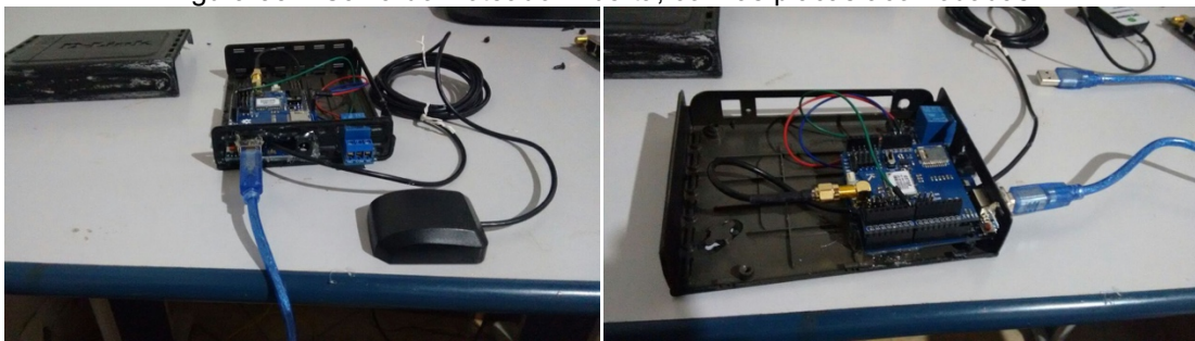
Figura 33 – Caixa do Roteador Aberta, com as placas acomodadas
