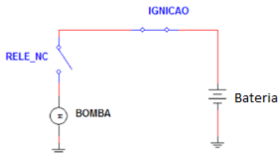
Figura 16 - Circuito da Bomba de Combustível do Veículo com Relé
