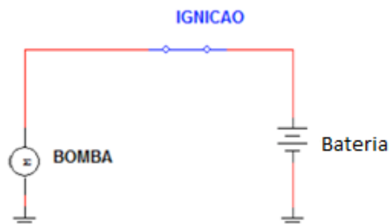
Figura 15 – Circuito da Bomba de Combustível do Veículo
