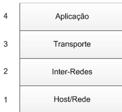
Figura 2 - Modelo TCP/IP
