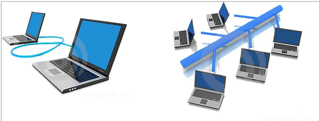
Figura 3 - Topologia Ponto-a-Ponto e Barramento
