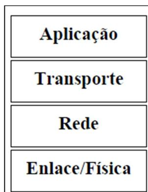
Figura 27 - Pilha de protocolos da Internet
