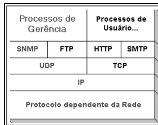
Figura 1 - Protocolo de Gerenciamento SNMP. Fonte – MELLO (2000)
