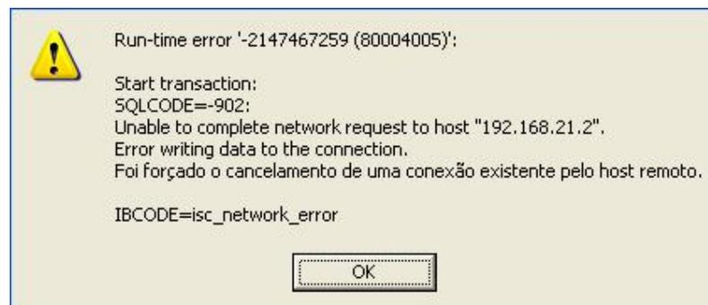
Figura 17 – Mensagem de erro, conexão de rede interrompida.
