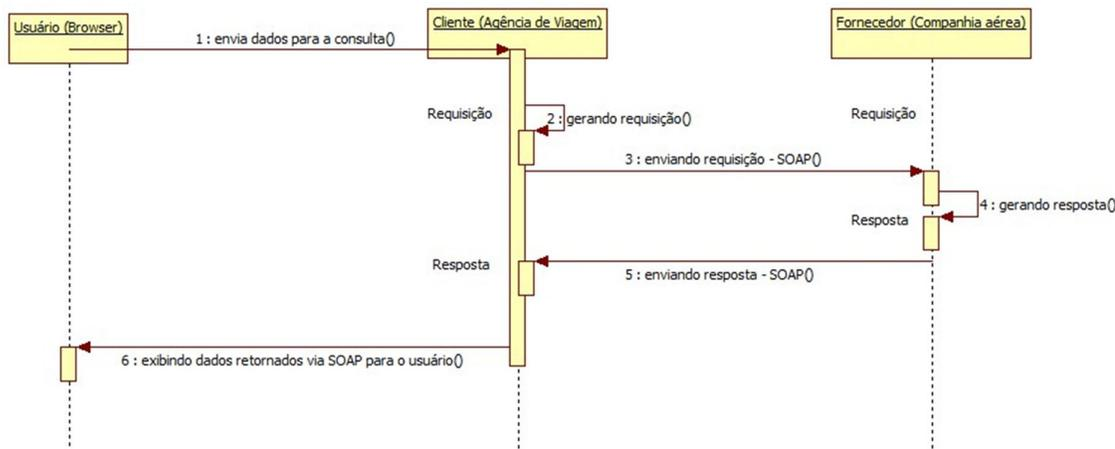
**Figura 1. Diagrama de sequência do funcionamento do sistema**
