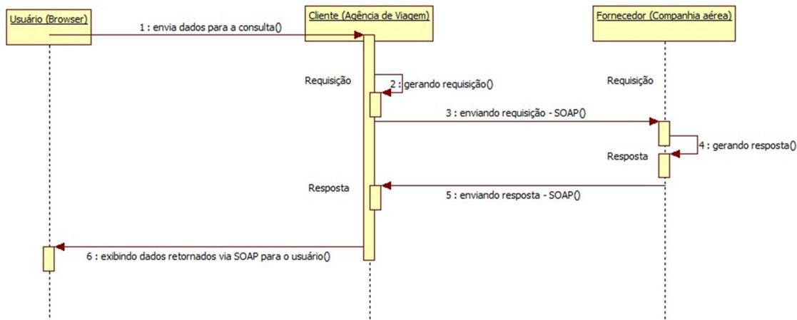
Figura 13 – Diagrama de sequência do funcionamento do sistema.
