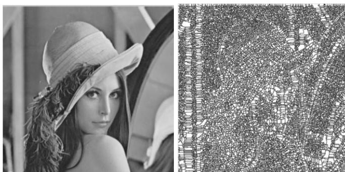
Figura 3.8 – Representação da imagem original e a aplicação da segmentação de *Watershed*
