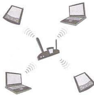
Figura 2 - Topologia modelo infra-estrutura Fonte: RUFINO (2005 apud LACERDA, 2007).
