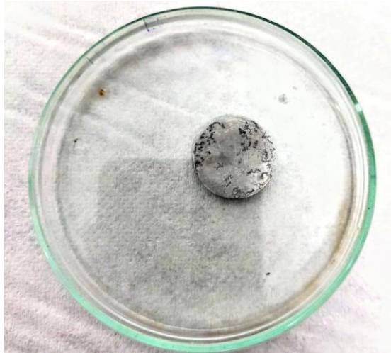
Figura 13. Corpos de prova 30 dias em meio corrosivo
