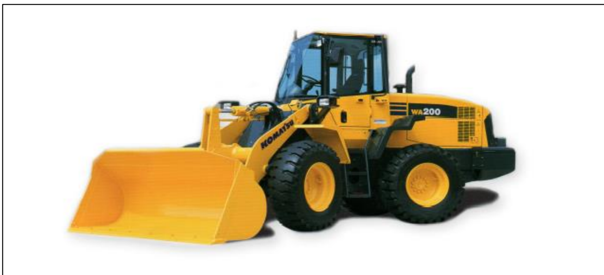
Figura 7: Pá Carregadeira KOMATSU WA200-5
