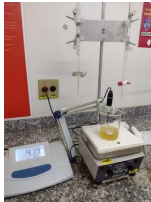
Figura 03 – Sistema de determinação de acidez livre: pHmetro, agitador magnético, béquer com amostra, suporte de bureta, buretas com reagentes
