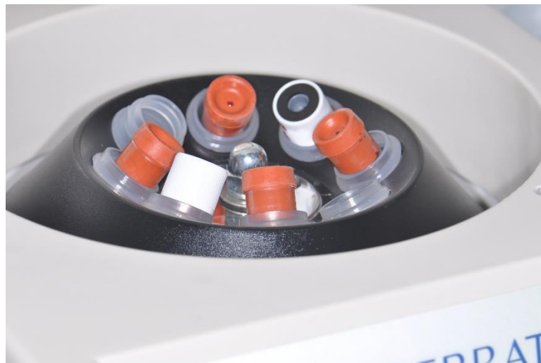
Figura 4-Posição correta dos tubos de tampa vermelha revestidos de sílica e os de tampa branca de plástico em posição correta para efetuar o balanceamento da centrífuga.
