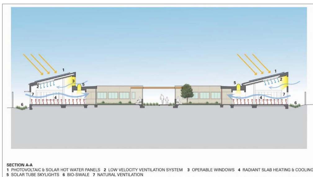
Figura 12. Comunidade Sweetwater. Entradas de Ventilação
